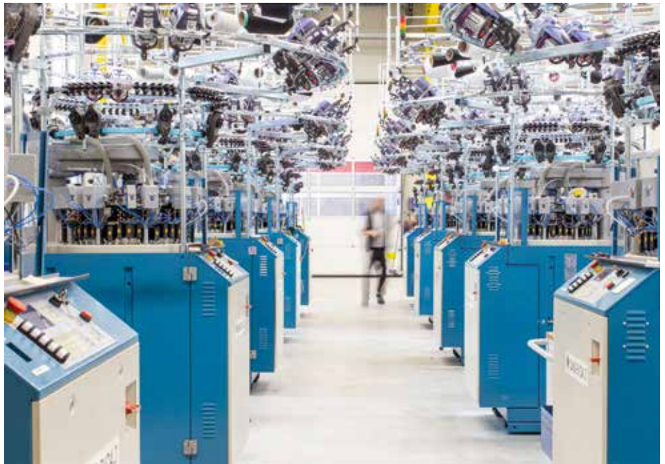
Auf modernen Rundstrickmaschinen fertigt Hexonia Unterwäschen und die hautnahen Combatshirts.
