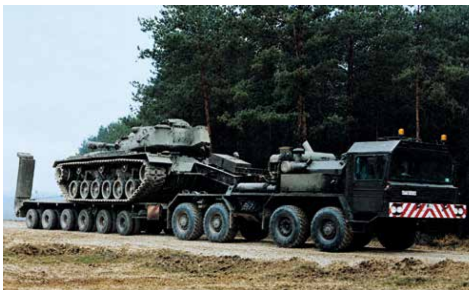
Der Schwerlasttransporter SLT 56 „Elefant“ der Bundeswehr mit luftgekühltem Zwölfzylinder-DEUTZ-Dieselmotor.
