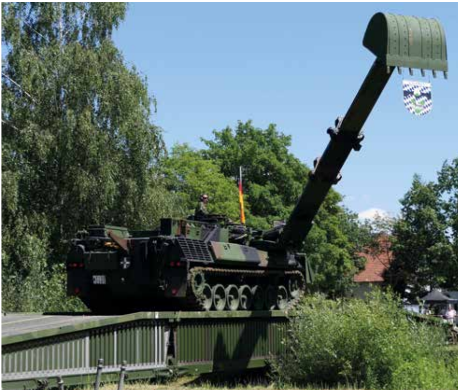
Der Pionierpanzer Dachs kann Schadfahrzeuge bergen, Hindernisse beseitigen oder bis zu 70 Tonnen über eine Seilwinde heben.
