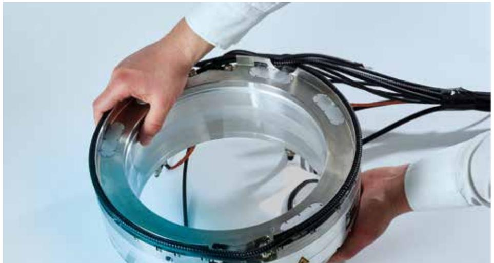
**Bild 4: Dieser Schleifring für die Schützenpanzer der schnellen NATO-Eingreiftruppe ist kompakt, unempfindlich gegen Umwelteinflüsse, extrem störfest und er bietet hervorragende EMV-Eigenschaften, sodass er die Daten zweier bidirektionaler Funkstrecken mit bis zu 3 Gbit/s übertragen kann**
