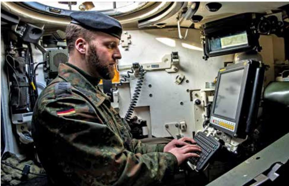
Über ein digitales Führungssystem werden Fahrzeuge, Soldaten und das Führungspersonal in der Operationszentrale miteinander verknüpft. Ein Soldat des Test- und Versuchsverbands in Munster bedient im Kampfpanzer Leopard ein digitales Führungssystem
