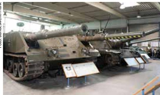
Der Versuchsträger VT 1-2 – ein Panzer in Kasemattbauweise mit zwei 120 mm Glattrohrkanonen – ursprünglich Mitte der 70er-Jahre entwickelt als möglicher Nachfolger des Leopard 1.
